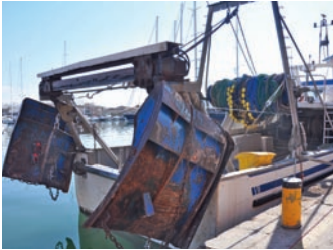
Embarcación de pesca de arrastre donde se pueden apreciar sus puertas y su red enrollada. Puerto de Palma de Mallorca. © OCEANA/ Marta Carreras
